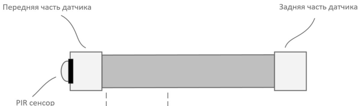
Рис. 1 Датчик вскрытия крышки люка
